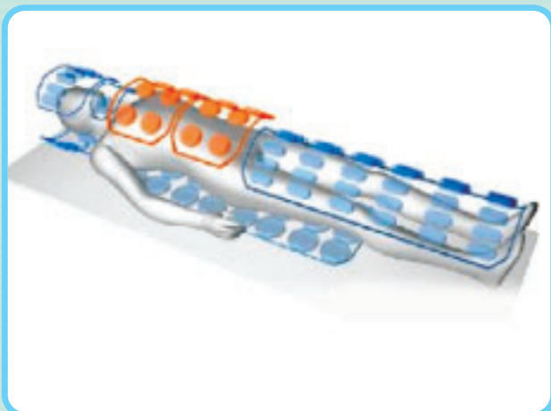
Figure 1: matrice d'antennes connectées aux 32 canaux RF
